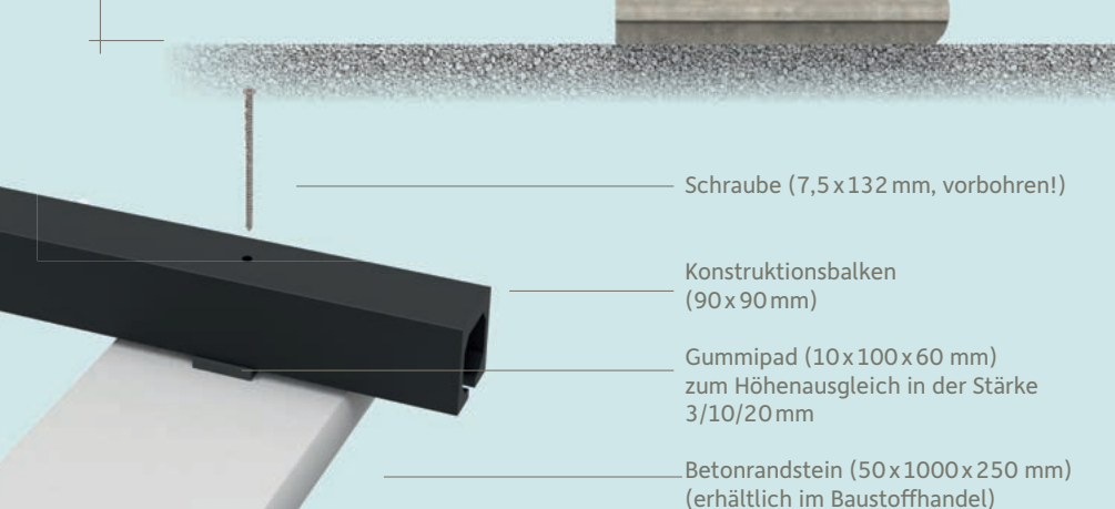
Geschlossene Fuge mit Nutleiste – erhöhter Aufbau gewährleistet die notwendige Unterlüftung
